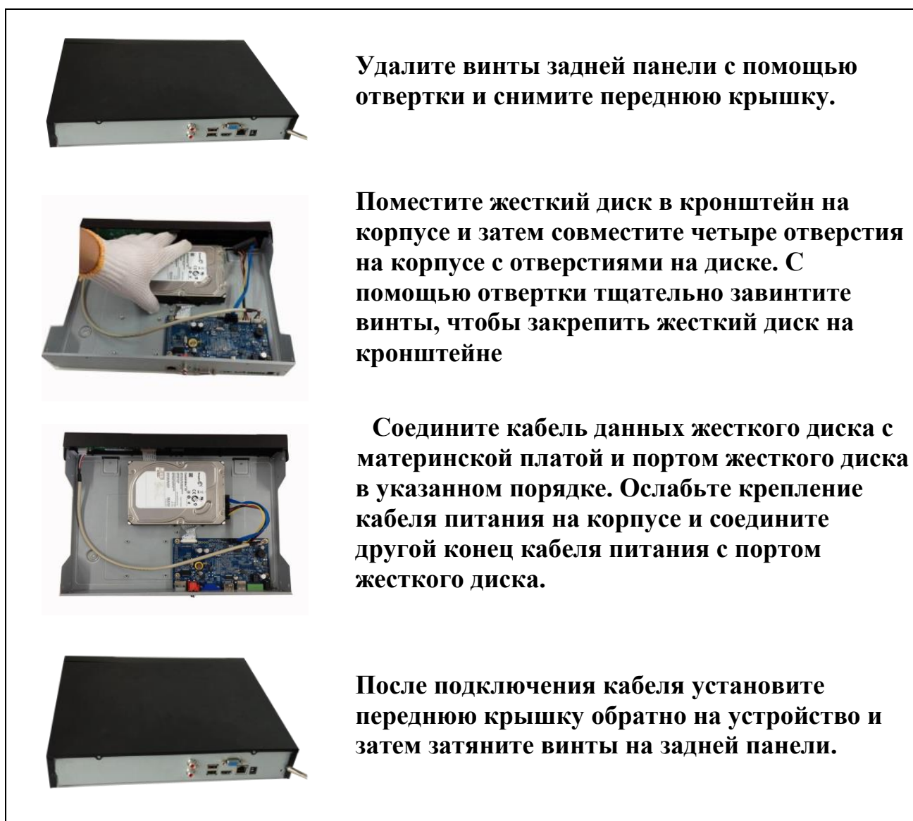
Рисунок 5.1 Установка жесткого диска
