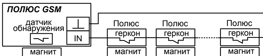
Рис.6а Схема подключения внешних датчиков. Значение «2» параметра №37
