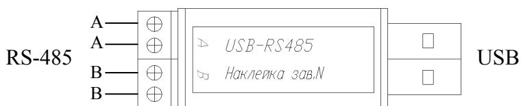
Рисунок 1 Схема подключения «USB-RS485»
