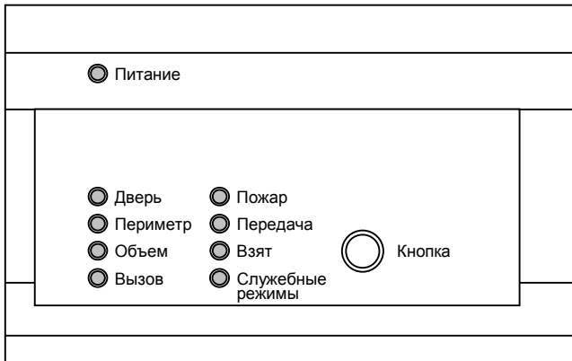
Рисунок 1. Внешний вид передатчика (надписи показаны условно)
