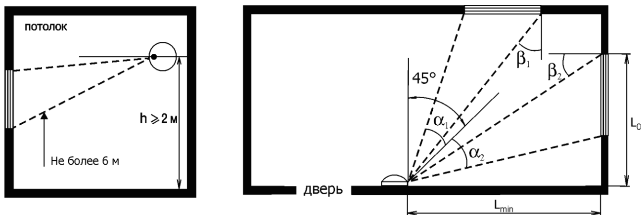
Рисунок А.3 – Установка на боковой стене
